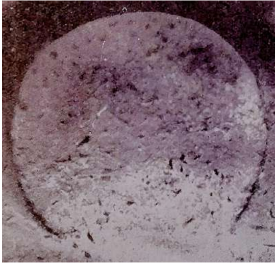
Figura 55a - Disco del lado derecho, marcas de picado resaltadas por la suciedad, cliché datado en década de 1920
